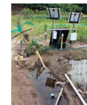
水田のCs収支を測定するための観測装置
